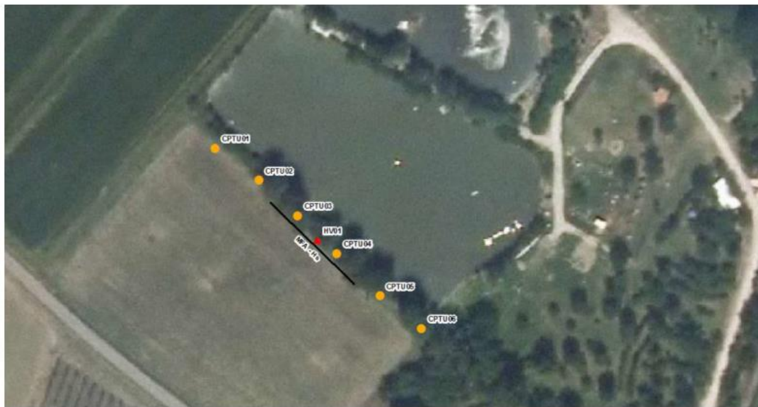
Figura 5.1: Ubicazione delle indagini geognostiche e sismiche.
