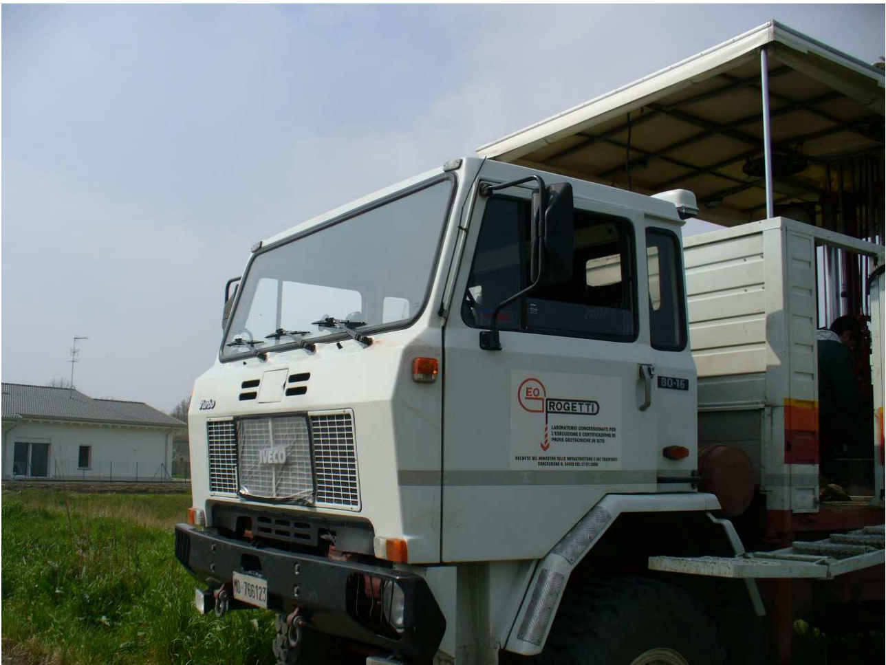
Fig.7. Penetrometro statico da 300 KN, montato su camion IVECO, utilizzato.
