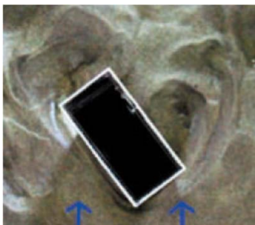
Figura 28: Esperimento di laboratorio, Dipartimento di Idraulica, Università di Pavia. Vista dall'alto di uno ostacolo rettangolare posto su letto sabbioso in seguito a simulazione.
