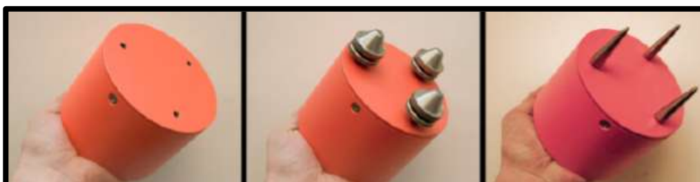
Figura A. 1 - Versione "GEMINI HVSr" basilare impiegata per la prospezione sismica passiva: dettaglio dei supporti intercambiabili in dotazione, da sostituire a seconda che si acquisisca su superficie rigida o su terreno.
