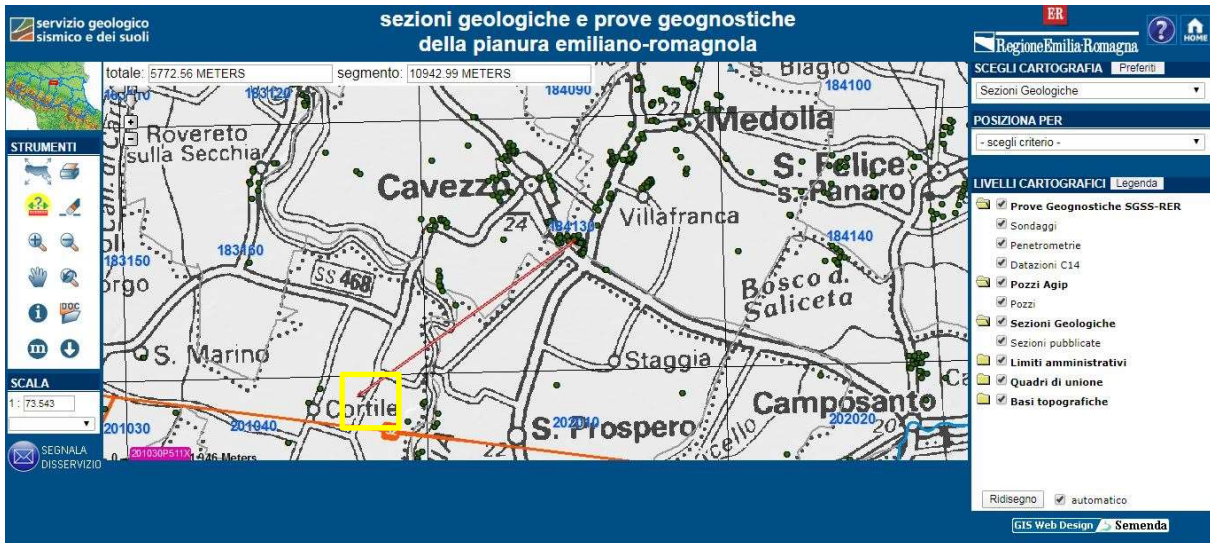
Figura 21 - Ubicazione del sondaggio Agip "CARPI-001", più prossimo all'area in esame (identificato dal quadrato giallo), la cui stratigrafia è stata utilizzata per estendere quella locale da -66 m fino a -160 m dal p.d.c.
