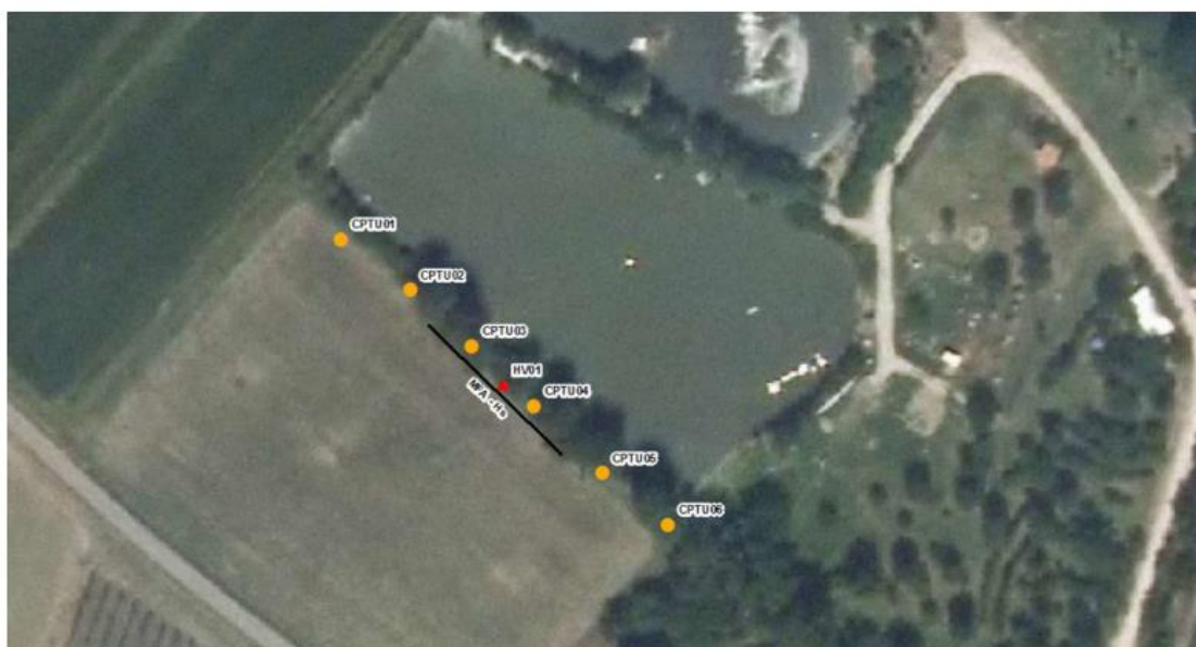
Figura 5.1: Ubicazione delle indagini geognostiche e sismiche.
